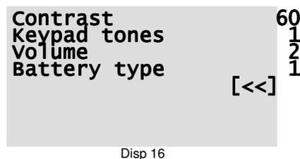
Auf den Parameter **Battery type** ist besonders zu achten, denn dieser legt fest, ob das Terminal mit Akkus (**0=Rechargeable**) oder Batterien (**1=Alkaline**) betrieben wird. Eine falsche Einstellung kann das Gerät beschädigen!
